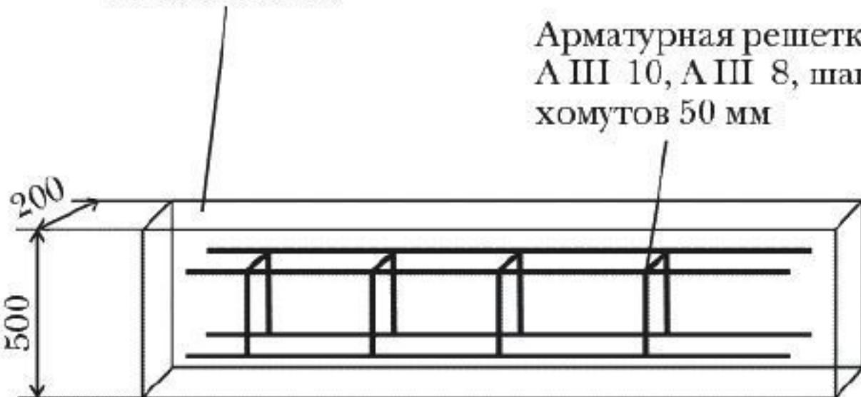
Рисунок 27. Фундамент для каменного забора (размеры указаны в миллиметрах)
