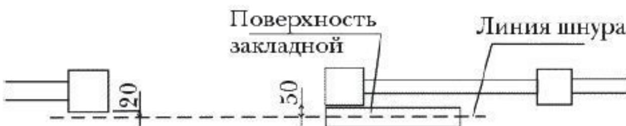
Рисунок 52. Отметка линии шнуром (размеры указаны в миллиметрах)
